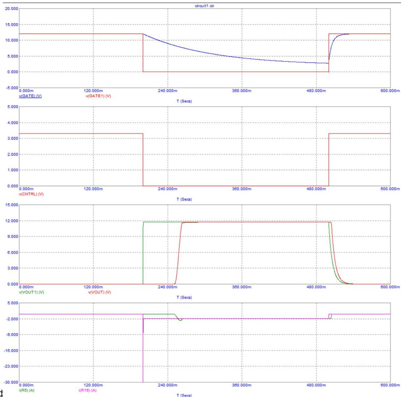
R9, R8 - делитель, задаёт напряжение на GATE транзистора
