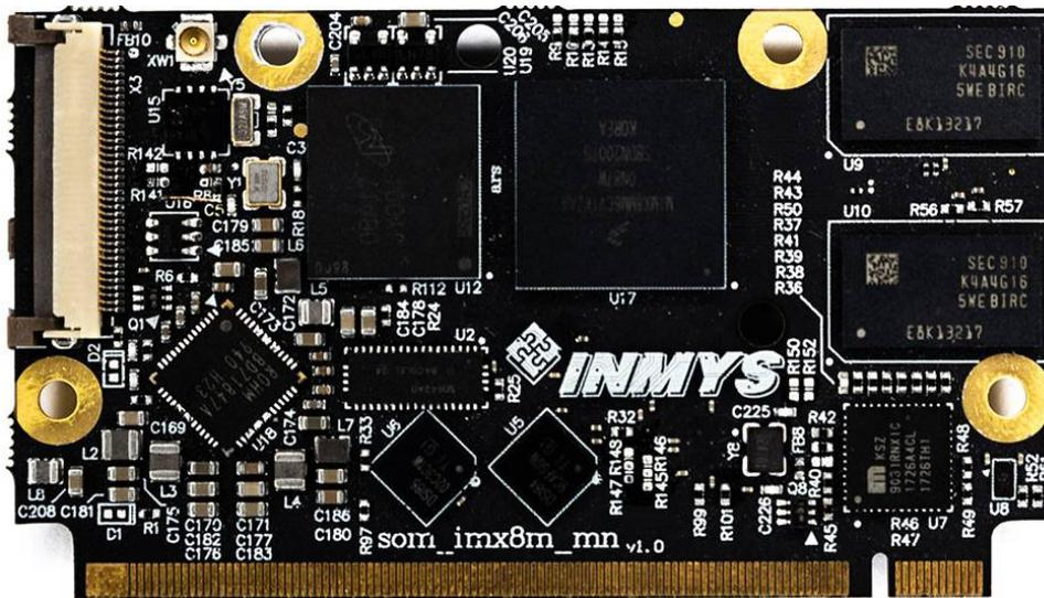
Процессорный модуль NMS-Q7-IMX8M-NANO выполнен на основе ARM-процессора производства NXP i.MX 8M nano.
