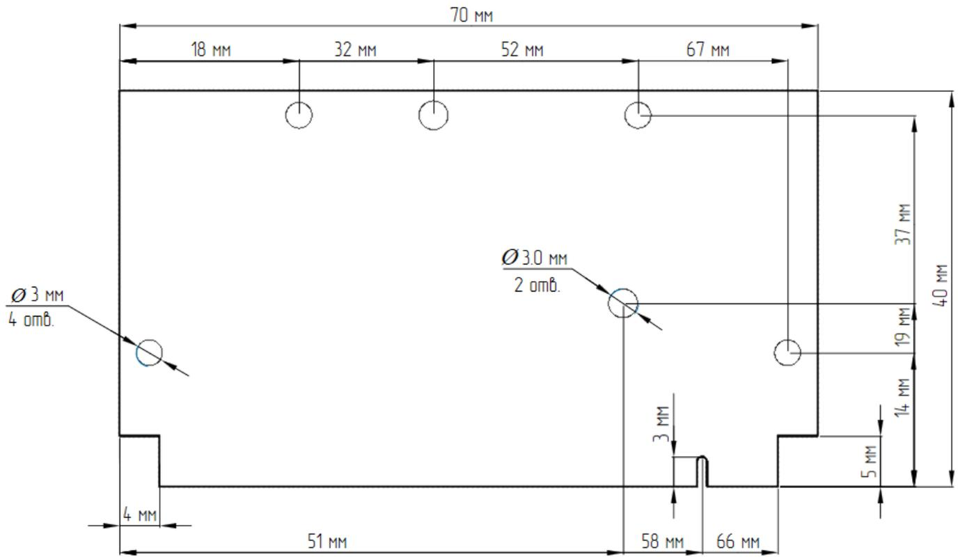
Рисунок 3: Габаритные размеры
