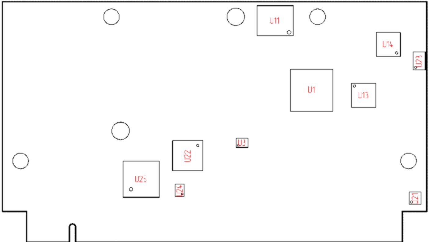
Рисунок 5: Расположение компонентов на плате. Вид сверху
