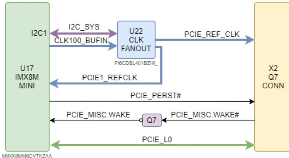
Рисунок 16: Блок-схема PCIe
