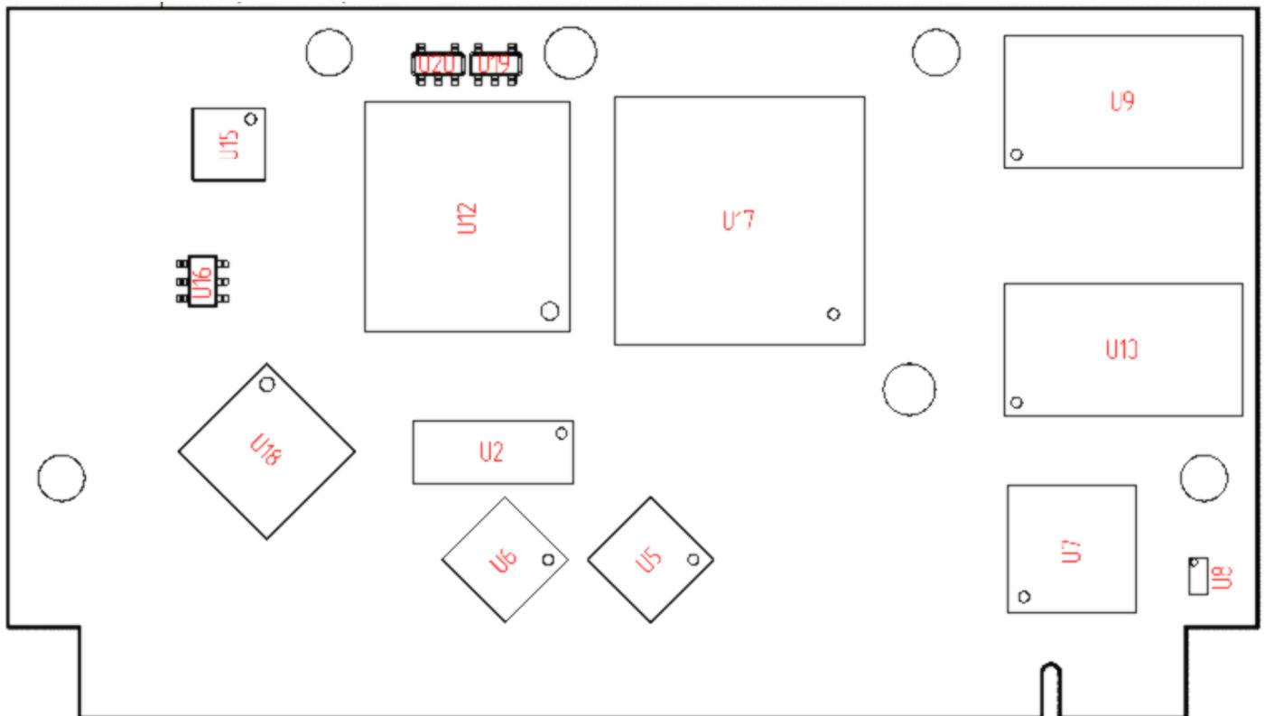
Рисунок 4: Расположение компонентов на плате. Вид сверху
