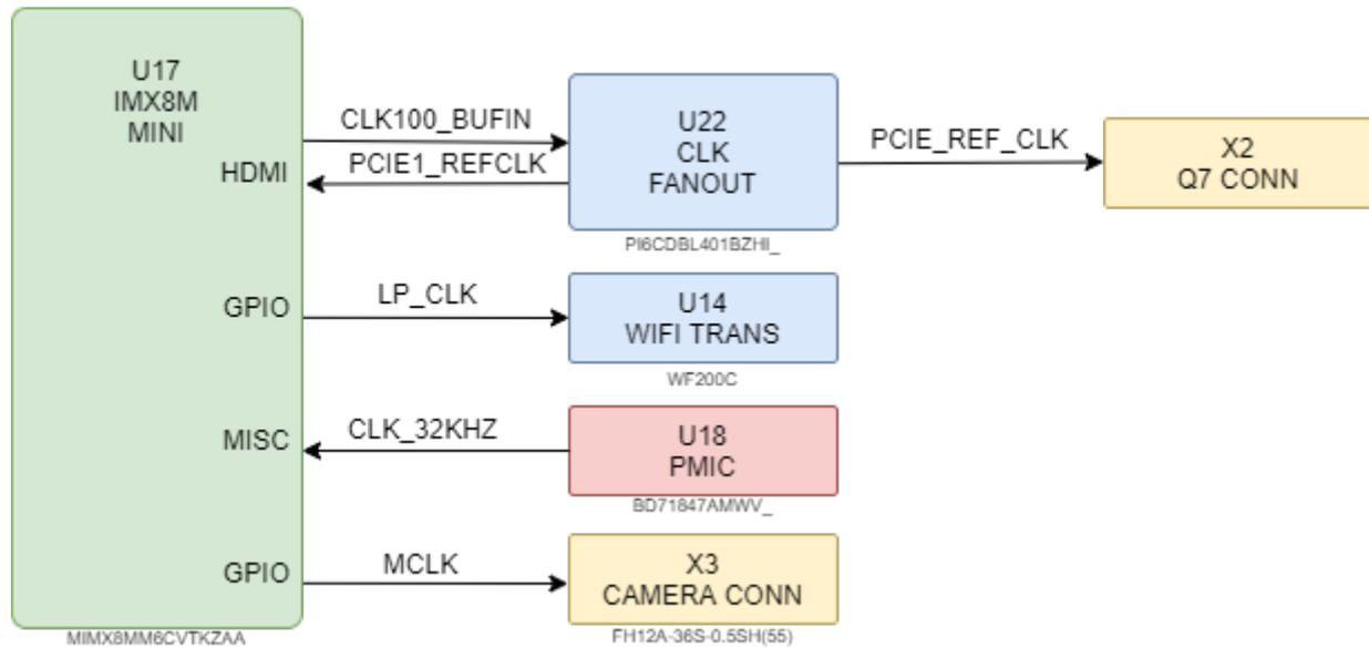
Рисунок 23: Тактовые сигналы imx8m mini
