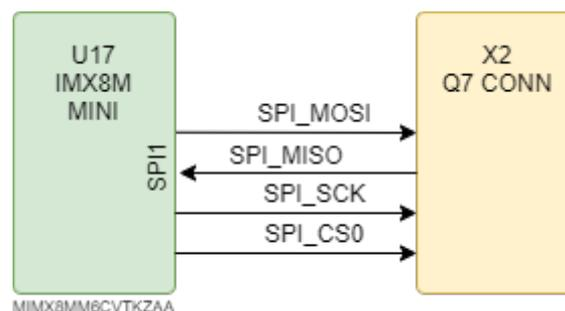
Рисунок 10: Интерфейс SPI
