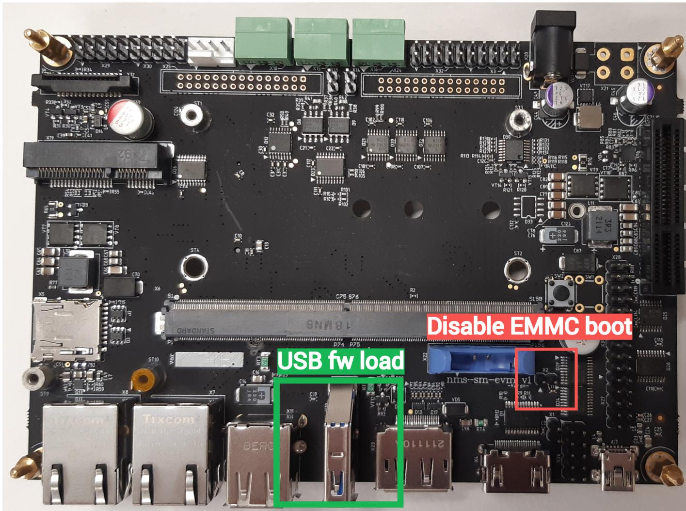
После подачи питания, модуль должен быть виден на шине USB хоста:
