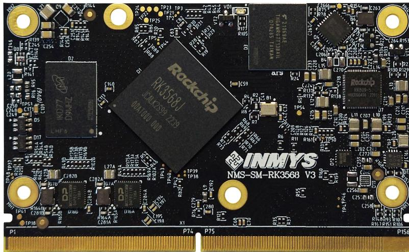
Процессорный модуль **NMS-SM-RK3568** выполнен на основе четырехъядерного 64-битного процессора Cortex-A55 RK3568 производства **Rockchip**, который оснащен двухъядерным графическим процессором и высокопроизводительным NPU, поддерживающим до 8 ГБ ОЗУ.
