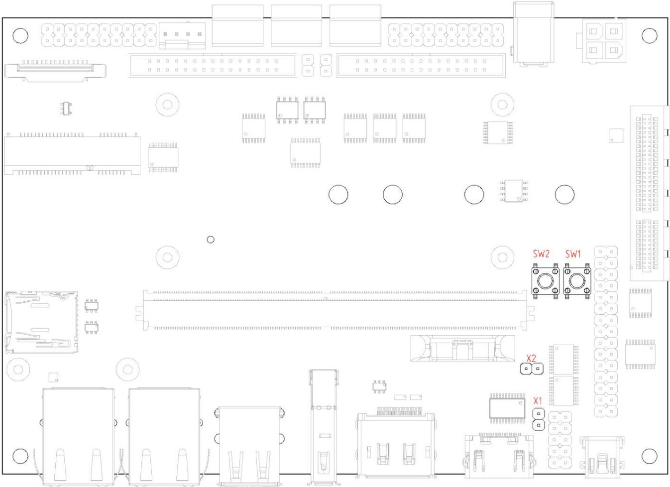
Рисунок 10: Расположение джамперов и кнопок на плате
