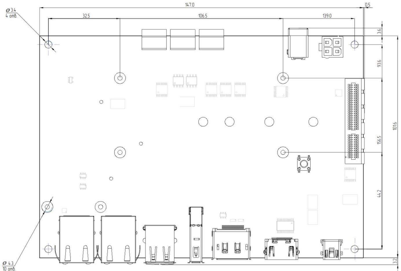
Рисунок 3: Габаритные размеры
