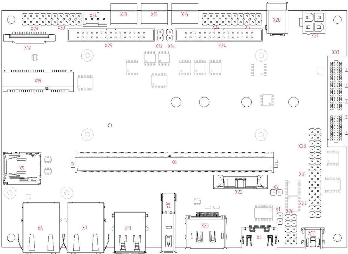
Рисунок 8: Расположение разъемов на плате. Вид сверху
