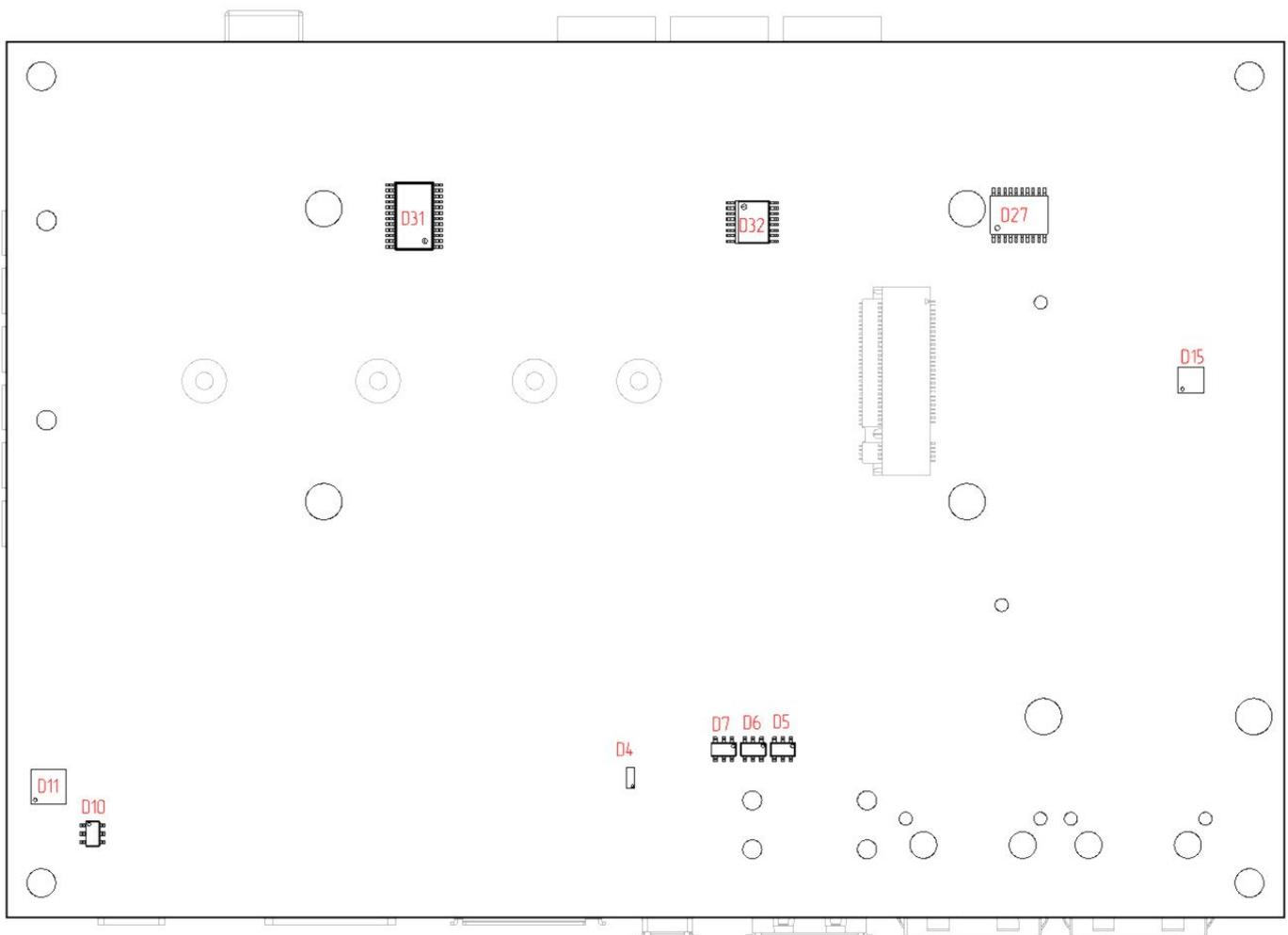
Рисунок 5: Расположение компонентов на плате. Вид снизу
