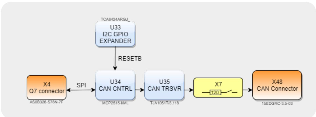
Рисунок 10: Блок-схема CAN интерфейса
