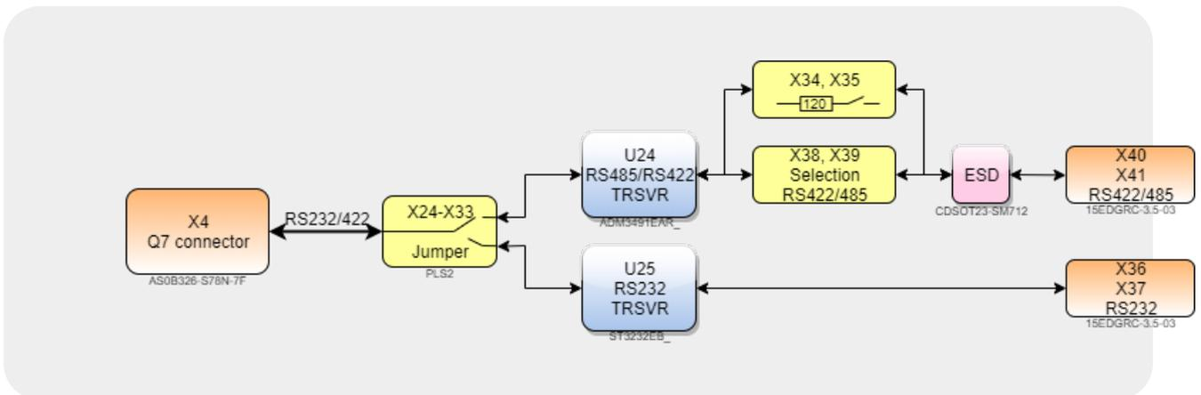
Рисунок 9: Блок-схема Rs232/422/485
