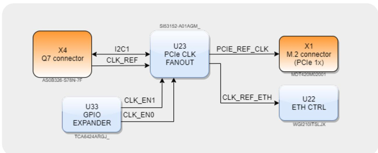
Рисунок 15: Буфер синхронизации PCIe
