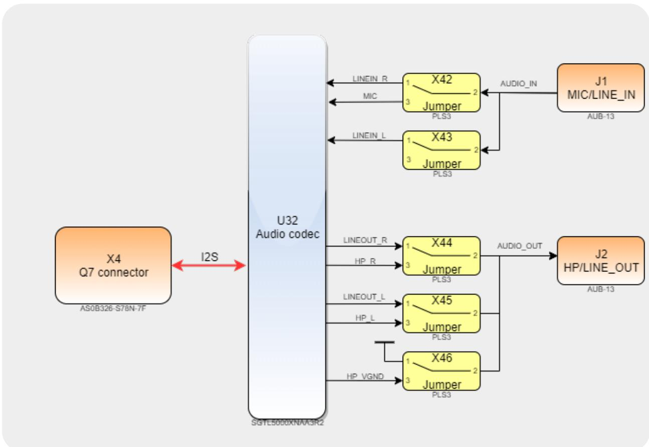
Рисунок 11: Блок-схема Аудио интерфейса
